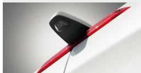
Світлодіодний стоп-сигнал і камера заднього ходу Кріплення на даху забезпечує максимальну оглядову можливість камери.
