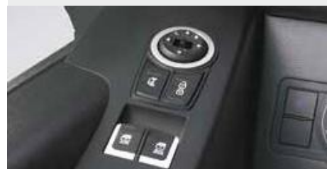
Перемикачі управління дверей Надають водієві контроль над вікнами передніх дверей та зовнішніх дзеркал заднього виду.
