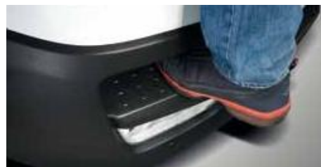
Передні сходинок розташовані на бампері Передні бамперні сходинок дозволяють легко дістатися до вітрового скла для його очищення що значно полегшує рутинну роботу з технічного обслуговування..
