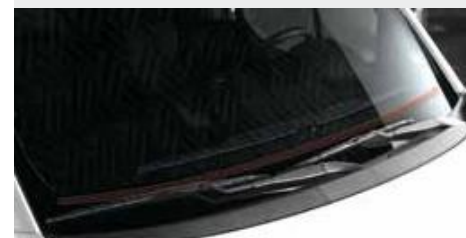
Підігрів вітрового скла (в зоні склоочисників) Нагрівальний елемент, вбудований в нижній частині вітрового скла..
