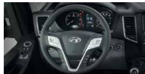
Рульове колесо Має опції регулювання кута нахилу та висоти.
