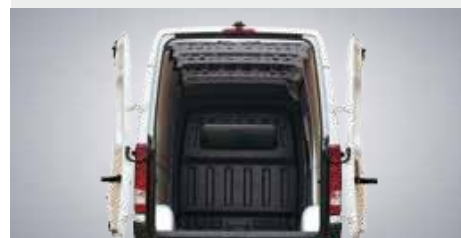
Задні двері, що відчиняються на 270 градусів Задні двері, які мають можливість відкриття до 270 градусів з фіксацією відкритого положення, мінімізують ймовірність випадкового пошкодження при навантаженні або розвантаженні автомобілю
